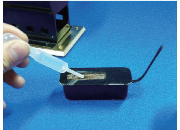
11. 計量した燃料用アルコールをスポイトでとり、燃焼皿に注入します。燃料をこぼした時は、濡れた布巾等で確実に拭き取って下さい。
