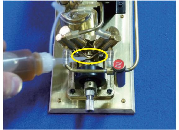
9. 写真の高速回転部にも少量注油します。注油量が多過ぎると、回転時に飛散するのでご注意ください。
