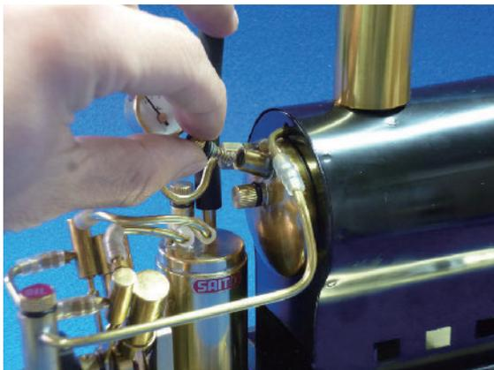
5. 給水後、検水口と安全弁のキャップを閉めて下さい。
