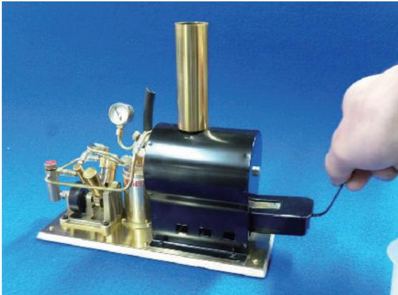
12. 給油後、燃焼皿をボイラー下へ入れて、奥まで確実に挿入して設置して下さい。
