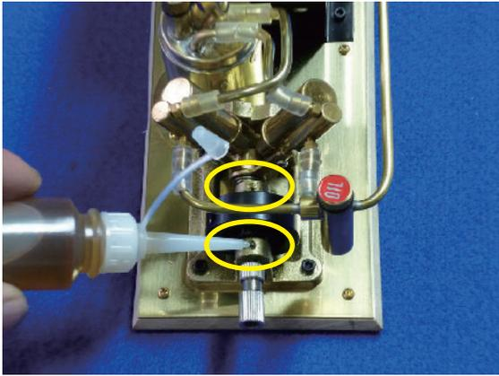
8. 軸受の注油孔（2箇所）に、マシン油（茶色）を注油します。
