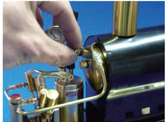
2. 上部の安全弁キャップを外します。
