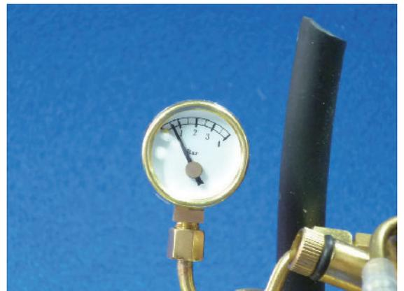
15. 圧力計がおよそ0.5bar（≒0.5気圧）を指すまで圧力が上昇したら、始動出来ます。
