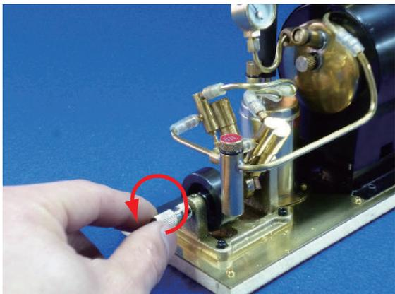
16. 始動用ツマミを反時計方向（矢印の向き）に回すと、エンジンが勢い良く回り始めます。
