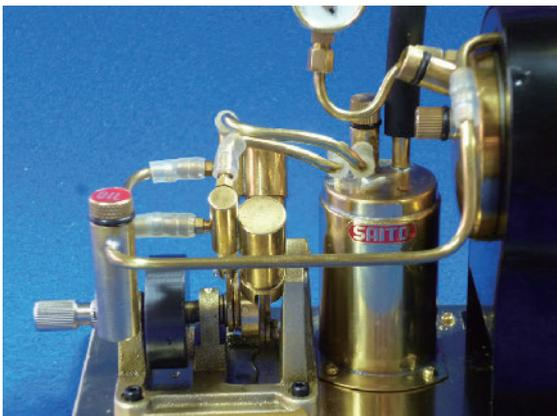
14. 外気温にもよりますが、点火から4～6分でボイラー内の水が沸騰し圧力が上がってきます。エンジンのシリンダーから蒸気が漏れてきますが、異常ではありません。
