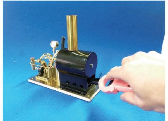
13. 安全のため、口細タイプのライターを燃焼皿に挿入し、点火して下さい。アルコールの炎は見えづらいのでご注意ください。
