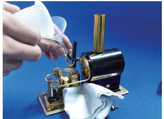
4. 安全弁口から、漏斗で給水します。キャップを外した検水口から水が溢れ始めるまで給水して下さい。空の状態から約100cc入ります。この時、検水口から水が溢れるので、布巾を敷くと良いでしょう。水は、蒸留水が最適ですが、通常のきれいな水道水であれば使用できます。サビやカルキ分の多い水、また硬水は使用しないで下さい。
