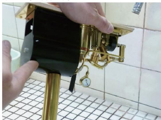
19. 運転が終了したら、本体が十分冷めてから、安全弁、検水口、オイル、ドレンタンクのキャップを全て外して、燃料皿を外してから、本体を逆さにして全ての液体を排出させて下さい。（廃液の処理は自治体の条例、規則に従って下さい。）本体に付着した液体は布で拭き取って下さい。
