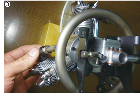
③マフラーナットを全てのアダプターに軽くねじ込みます。3つ全て指で2〜3回転くらいはネジに入るように位置を合わせて下さい。ナットをアダプターに対し垂直にそろえる事が肝心です。無理やりにねじ込むと、リングマフラーを破損します。※3つのマフラーナットの位置がうまく合わない場合は、アダプターをそれぞれ入れ替えて下さい。 ③Insert 3 nuts of the ring muffler into each adapter. Adjust position that all threads can be turned about 2~3 turns by fingers. The key is aligning each nut and adapter vertically. Never tighten by force otherwise you may break thread. ※If you can't fit the position, replace adapters each other.
