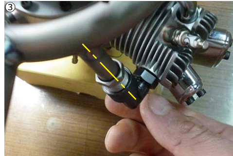
③マフラーナットを全てのアダプターに軽くねじ込みます。3つ全て指で2〜3回転くらいはネジに入るように位置を合わせて下さい。ナットをアダプターに対し垂直にそろえる事が肝心です。無理やりにねじ込むと、リングマフラーを破損します。※3つのマフラーナットの位置がうまく合わない場合は、アダプターをそれぞれ入れ替えて下さい。 ③Insert 3 nuts of the ring muffler into each adapter. Adjust position that all threads can be turned about 2~3 turns by fingers. The key is aligning each nut and adapter vertically. Never tighten by force otherwise you may break thread. ※If you can't fit the position, replace adapters each other.
