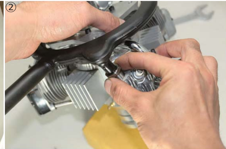
②リングマフラーナットを全てのシリンダーに軽くねじ込みます。3つ全て、指でスムーズに回るように位置を合わせて下さい。無理やりにねじ込むと、シリンダーを破損します。 ②Insert 3 nuts of the ring muffer into each cylinder. Adjust position that all threads can be turned smoothly by your fingers. Never tighten by force, or you may break the cylinders.
