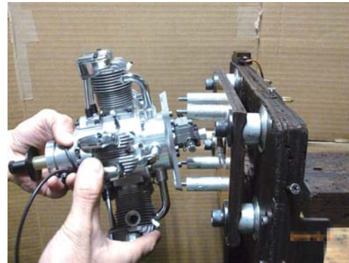
9. 変換マウントの孔を4本のボルトに合わせ、エンジンを取り付けます。
