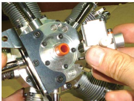
3. キャブジョイントプレート下部のねじを外し、キャブレターをプレートごと本体から外します。
