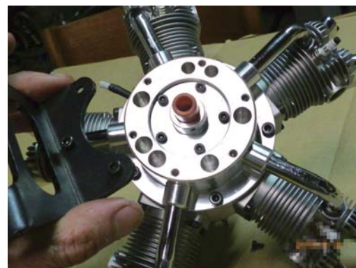
4. 左側マウントのねじを外し、左側マウントを外します。
